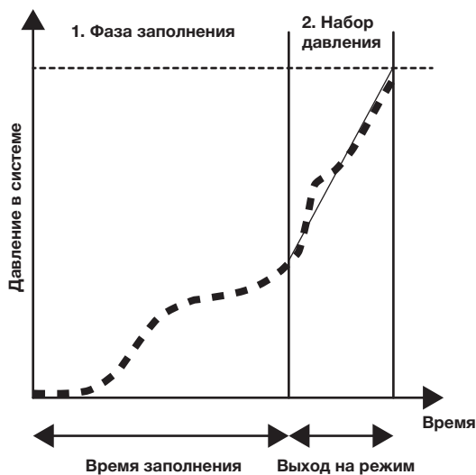
Рис. 46 Запуск СМВЕ при активированной функции плавного заполнения труб
