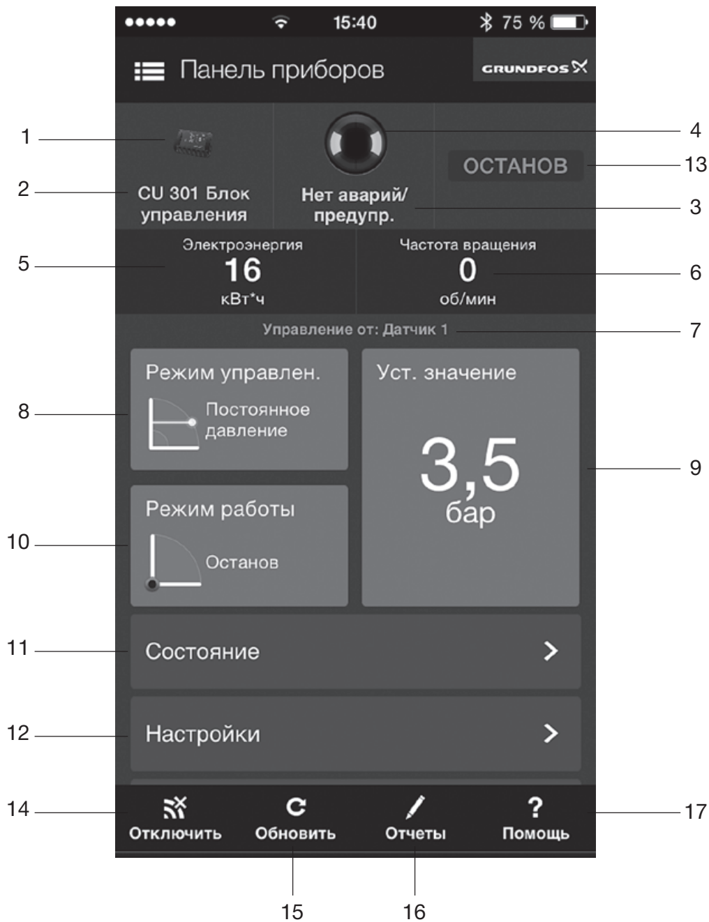
Рис. 25 Устройство беспроводного управления Grundfos GO Remote
