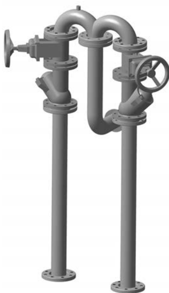
Рис. 6 GC, обвязка с S-образным коленом
