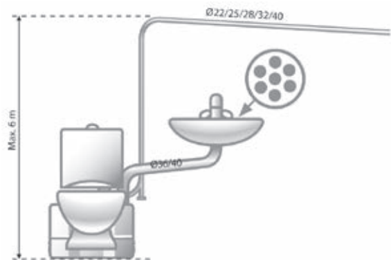
Рис. 48 Для напольного унитаза (SOLOLIFT2 WC-1)
