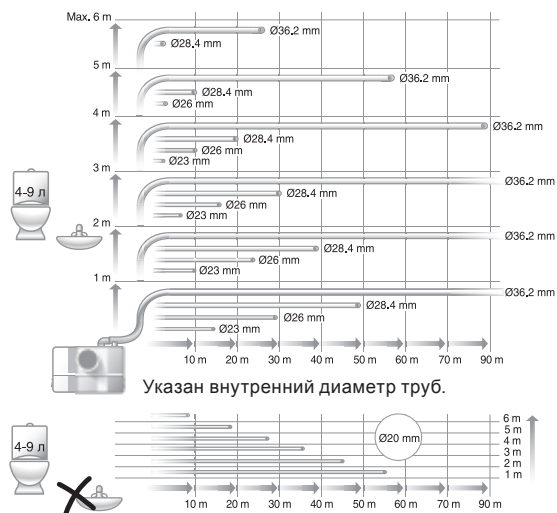
Рис. 55 Максимальная длина вертикальных и горизонтальных сливных труб
