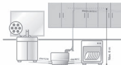
Рис. 53 Для стиральной или посудомоечной машины и кухонной мойки (SOLOLIFT2 C-3)
