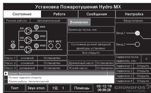
Рис. 82 Пример мнемосхемы на панели контроллера
