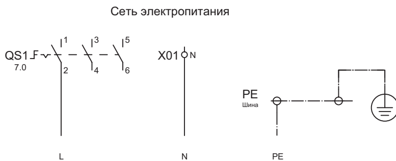
Рис. 54 Подключение питающей сети для однофазных шкафов.
