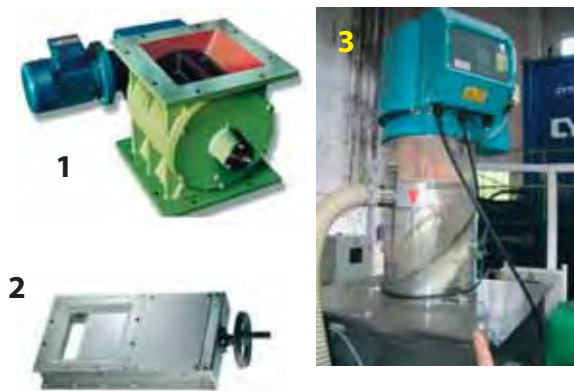
Рис. 46. Устройства для загрузки сухого полиэлектролита в шнековый дозатор установки Polydos - 412.
