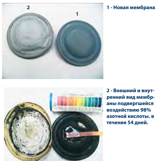
Рис. 71. Химическая деструкция и отслоение внутренней части мембраны, армированной EPDM.
