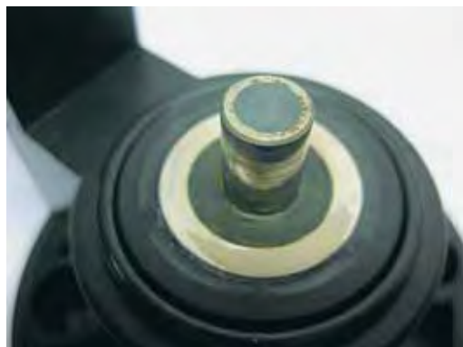
Начало образования карбонатных отложений на электроде 12.6541-301.
