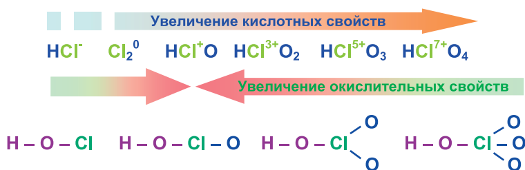
Рис. 72. Изменение кислотных и окислительных свойств кислородсодержащих соединений хлора.
