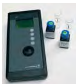
Рис. 31 Фотометр DIT с реагентом Хлор Cl 2 Реагент 1 и пробирками для измерения хлора.
