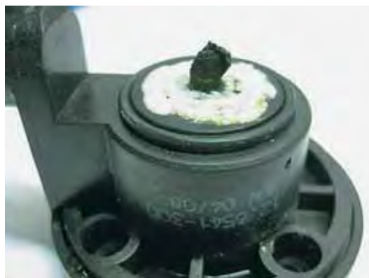
Рис. 49. Разрушение измерительного электрода.
