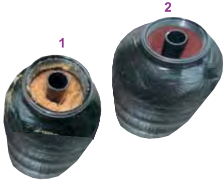
Рис. 28 Умягчитель установки Selcoperm 125 с новой смолой (1), и со смолой, загрязнённой железом (2)
