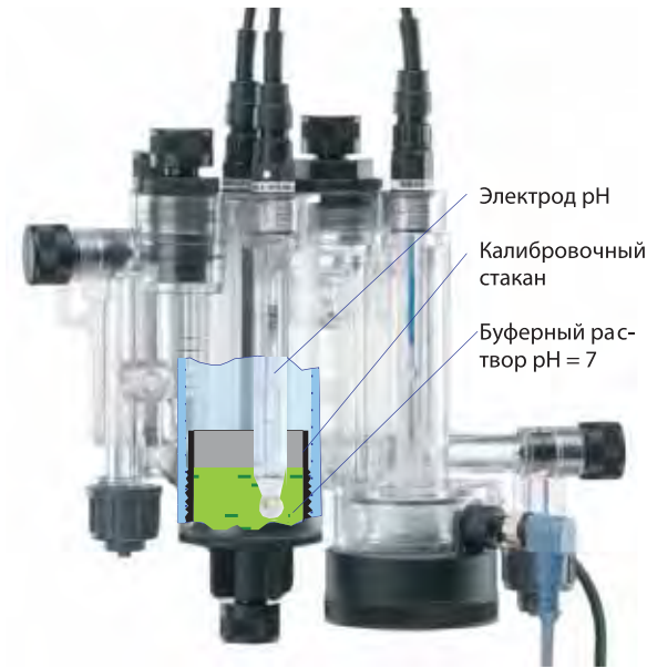
Рис. 15 Калибровка pH электродов в измерительной ячейке AQC D2
