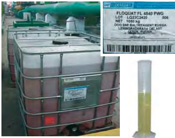
Рис. 45. Транспортная ёмкость с флокулянт FLOQUAT FL 4540 PWG, концентрация 42%.
