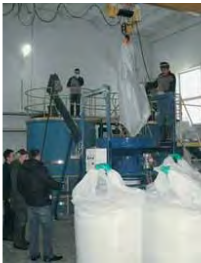
Рис. 92. Процесс загрузки хлорида натрия в бункер транспортёра перед его подачей в сатуратор (стадия пуско-наладочных работ).
