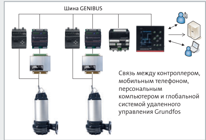
Рис. 13. Полный обзор системы с модулями управления Grundfos для двух насосов SL, SE и S, сенсорное исполнение, мощность двигателя от 9 до 520 кВт.
