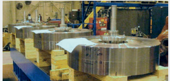
Рис. 8 Маховики насосных станций в США. Диаметр маховика — 864 мм, высота — 247 мм, момент инерции — 106 кг·м 2 .
