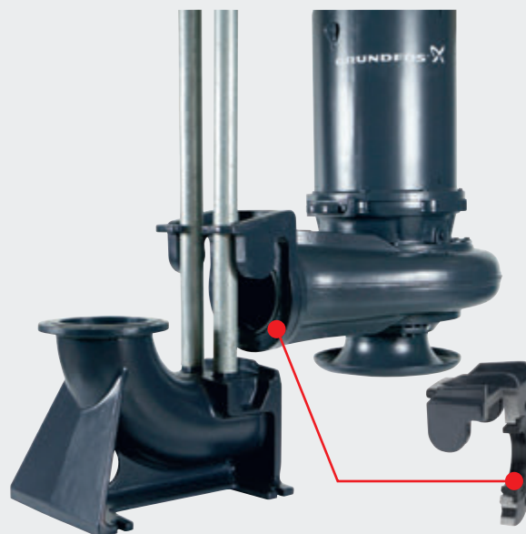
Рис. 5 Система Grundfos SmartSeal с резиновым профильным уплотнением, установленным между напорным фланцем насоса и фланцем кляка направляющей.
