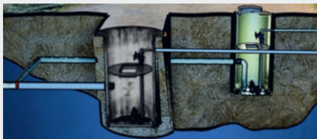
Рис. 44 Байпасная установка с новой подводящей трубой к новой станции.
