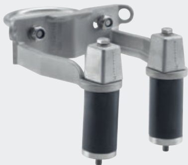
Рис. 9 Промежуточный кронштейн направляющих; необходим, если длина направляющих превышает 6 м. Промежуточный кронштейн направляющих устанавливается на вертикальной напорной трубе при помощи хомута из нержавеющей стали.
