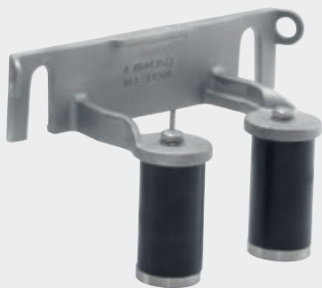
Рис. 8 Верхний кронштейн для двух направляющих с резиновыми вставками для исключения шума.
