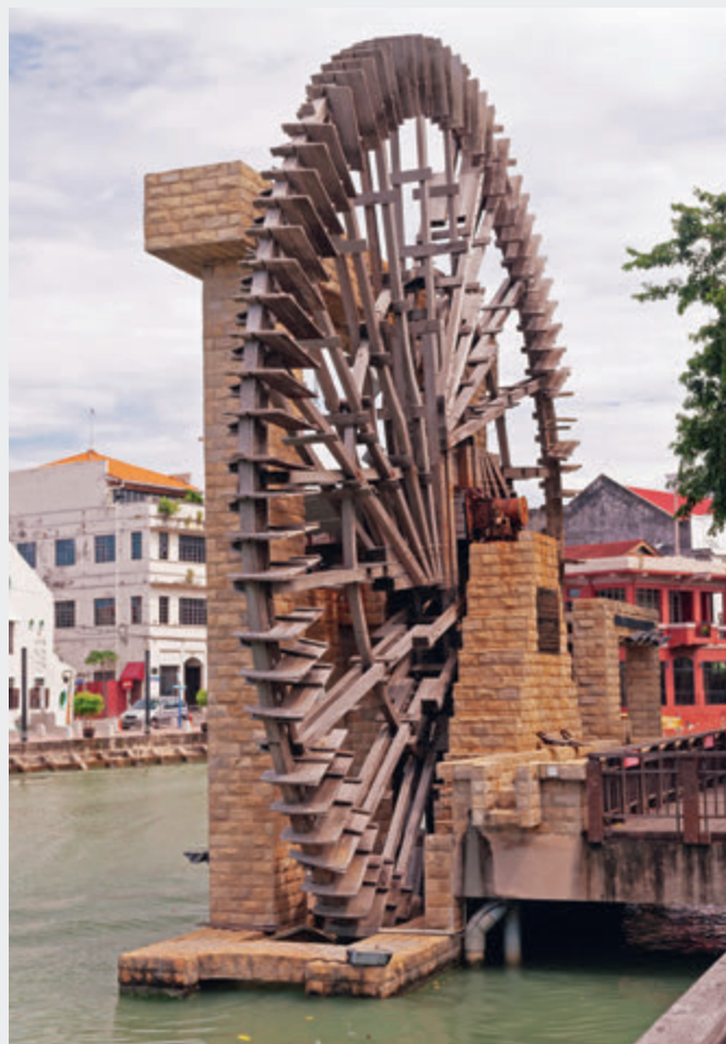
Рис. 3 Водяное колесо — это механическое устройство, преобразования энергии свободного течения или падения воды в полезную энергию, как правило, для приведения в действие водяной мельницы. Конструкция состоит из большого деревянного или металлического колеса, нескольких лопастей или ковшей, установленных по внешнему периметру колеса и образующих приводную поверхность.
