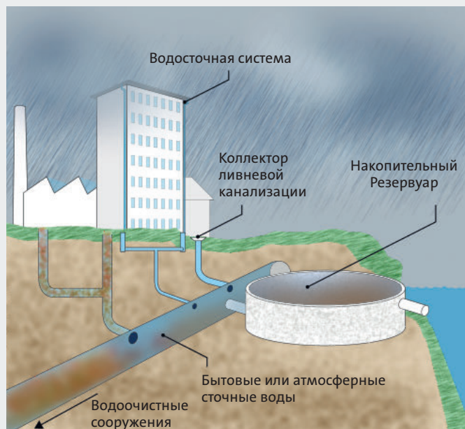
Рис. 9 Общесплавная система водоотведения с интегрированным накопительным резервуаром во время выпадения осадков.
