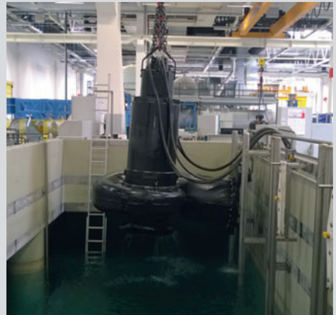
Рис. 3 Погружной канализационный насос серии S для установки на автоматическую муфту в испытательном стенде.
