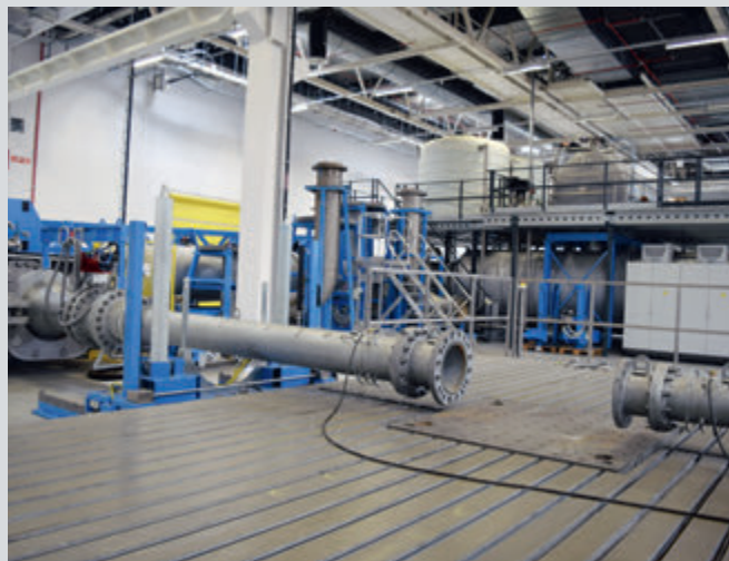
Рис. 5 Виброиспытания насоса с разъемным корпусом (не применяются для погружных канализационных насосов).
