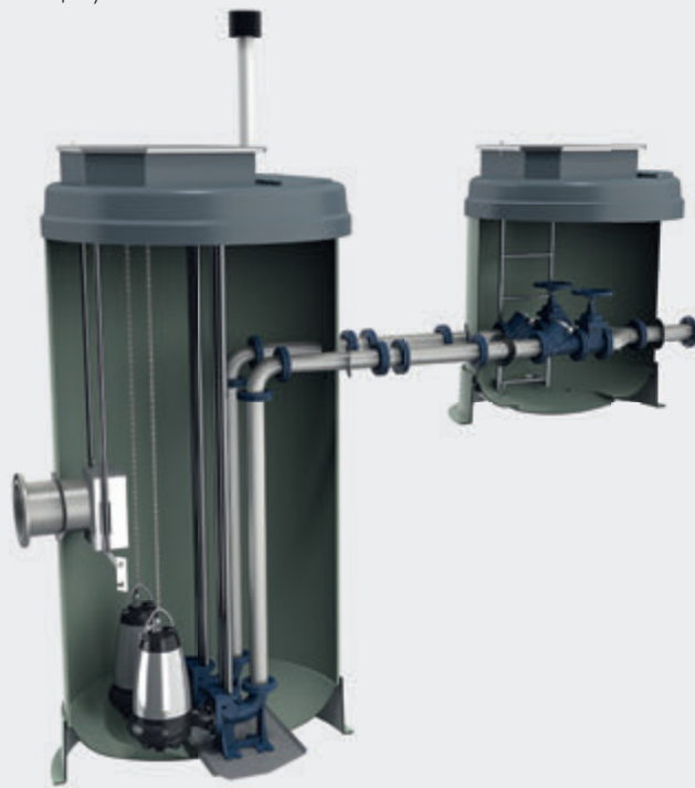
Рис. 22 Насосная станция с двумя погружными насосами в системе с автоматической муфтой. С трубопроводной системой VC и камерой переключения.
