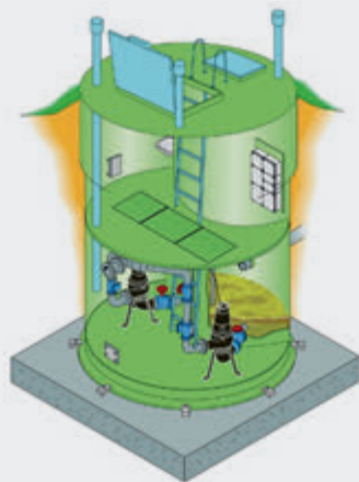
Рис. 37 Насосная станция индивидуального исполнения (INTEGRA) с насосами сухой вертикальной установки и с интегрированным накопительным резервуаром.
