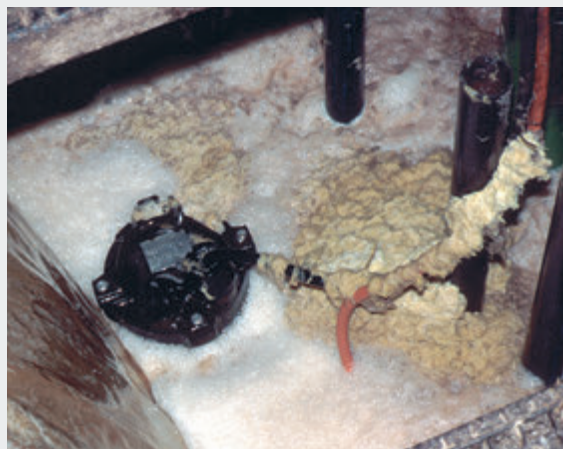
Рис. 2 Один из двух насосов серии S, используемых в производстве стекловаты для перекачивания воды с высоким содержанием абразивных частиц.
