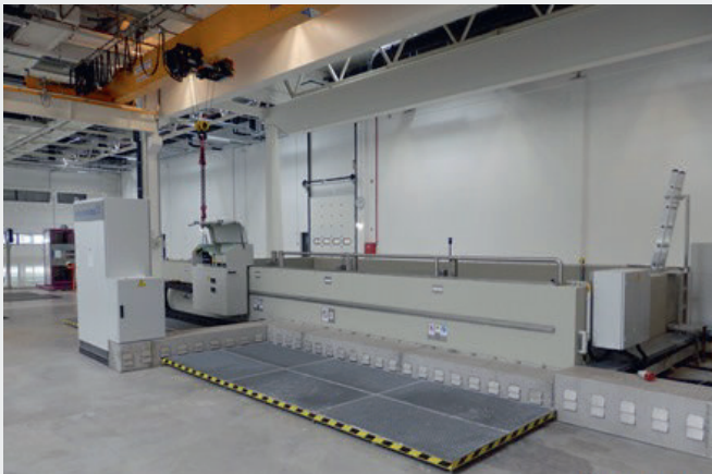
Рис. 2 Испытательный стенд для погружных канализационных насосов.
