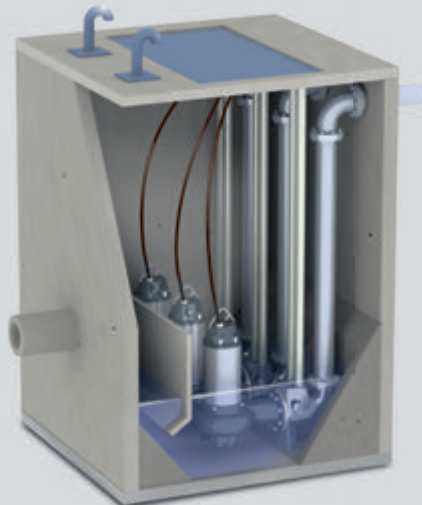
Рис. 9 Прямоугольная бетонная насосная станция с экраном перед подводящей трубой и тремя погружными канализационными насосами с коленом-основанием в системе с автоматической трубной муфтой на бетонном основании.
