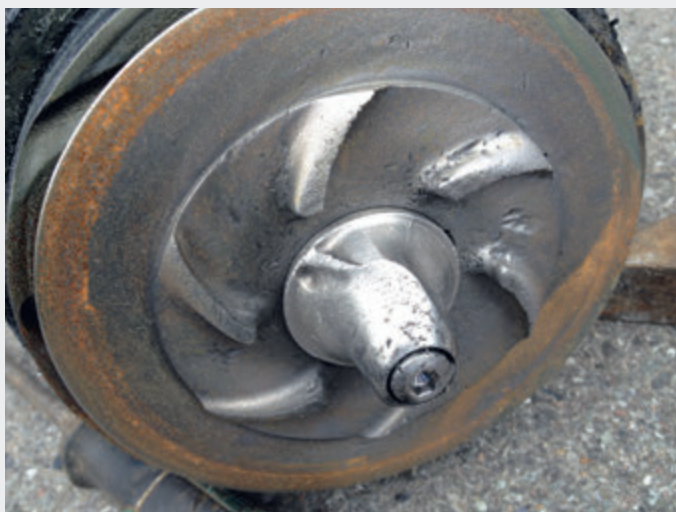
Рис. 11 Насос с рабочим колесом с режущим механизмом через год работы в условиях высокого содержания песка.
