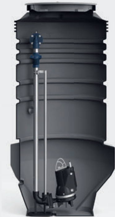
Рис. 4 Канализационная станция для установки одного погружного насоса с режущим механизмом SEG AUTOADAPT на автоматической муфте. Диаметр резервуара — 800 мм, диаметр основной секции — 600 мм.
