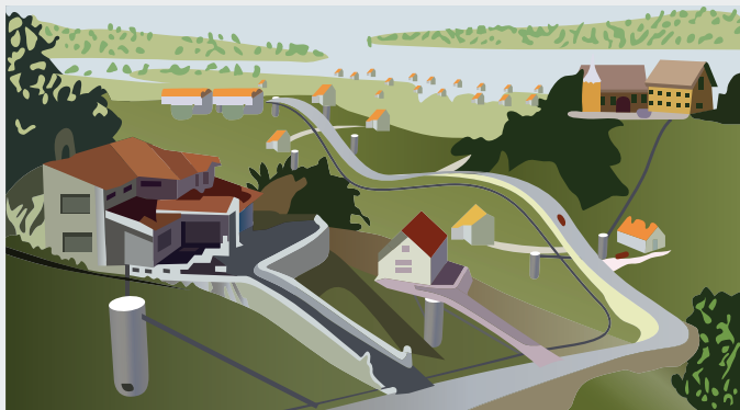
Рис. 2 Наружная напорная система канализации удалённого населённого пункта, с применением насосов с режущим механизмом.
