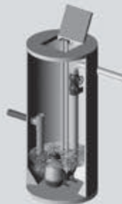
Рис. 10 Резервуар и конструкция подводящего трубопровода с рассекателем.
