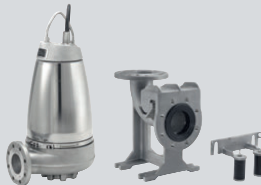
Рис. 15 Для перекачивания коррозионных жидкостей с высокой скоростью потока оптимальный выбор — погружной канализационный насос, выполненный полностью из нержавеющей стали на автоматической муфте с направляющими из нержавеющей стали и верхним кронштейном крепления направляющих.
