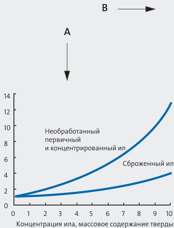
Рис. 3 Коэффициенты увеличения потерь напора. На графике А показаны различные типы и концентрации ила, на графике В показаны различные значения скорости потока и концентрации твердых примесей в бытовом стоке.
