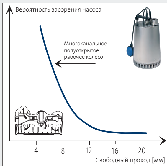
Рис. 3 Вероятность засорения насоса в зависимости от свободного прохода насоса. Для исключения засорения насоса значение свободного прохода должно составлять от 10 до 12 мм.
