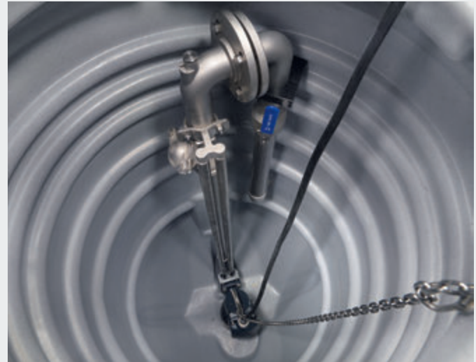
Рис. 5 Компоновка простой насосной установки с S-образным коленом и газовыпускным вентилем.
