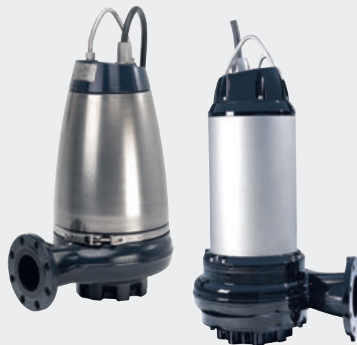
Рис. 2 Погружные насосы Grundfos серии SE с кожухом двигателя и системой охлаждения могут непрерывно работать как в полностью погруженном состоянии, так и при сухом монтаже.
