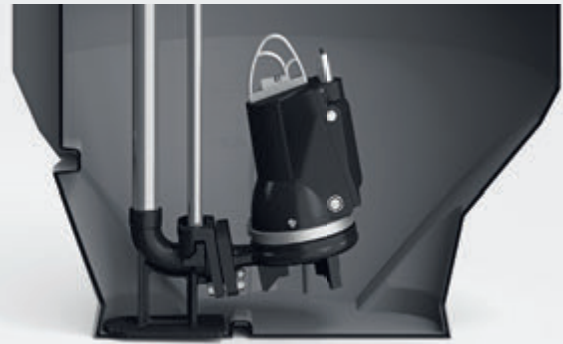
Рис. 5 Выемка на дне резервуара используется для удержания автоматической муфты в правильном положении без крепления ко дну резервуара.
