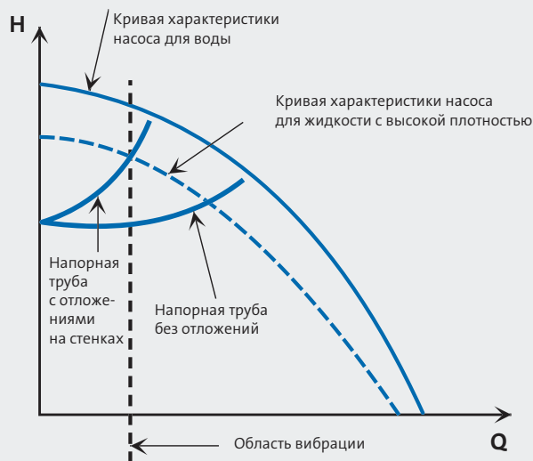
Рис. 1 Влияние на работу насоса перекачиваемой жидкости высокой плотности.
