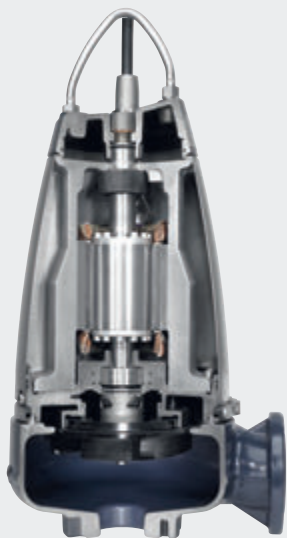
Рис. 5 Погружной канализационный насос с рабочим колесом SuperVortex.
