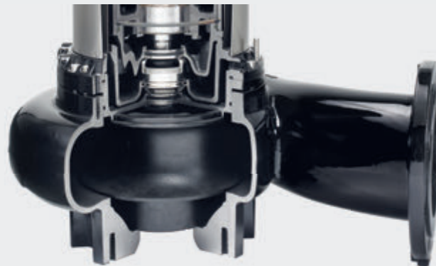
Рис. 11 Рабочее колесо S-tube® без кольца щелевого уплотнения и уплотнительного кольца в корпусе насоса с системой SmartTrim .
