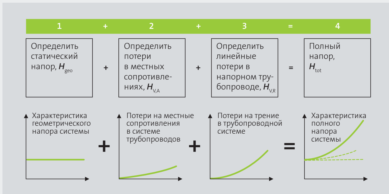
Рис. 12 Расчет суммарного напора H_{tot} .
