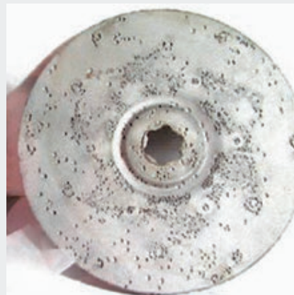
Рис. 5 Питтинг вследствие кавитации с обратной стороны рабочего колеса.
