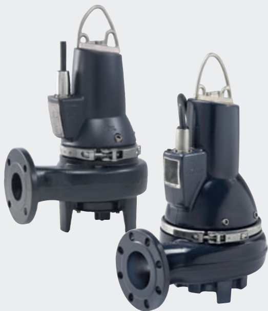
Рис. 1 Погружные насосы Grundfos серии SL и другие насосы малой мощности из чугуна без системы охлаждения могут непрерывно работать при полном погружении.
