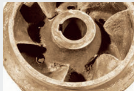
Рис. 6 Характерная кавитация на входе в рабочее колесо.
