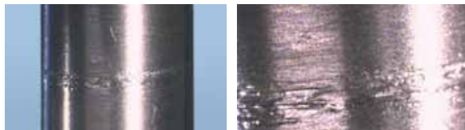
Рис. 5.18. Коррозия вала под вращающейся частью уплотнения в результате осевого движения вала
