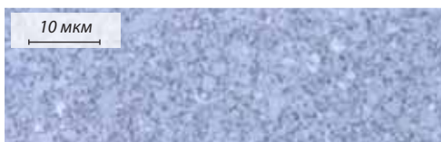
Рис. 3.5. Микроснимок поверхности карбида вольфрама
