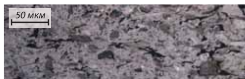
Рис. 3.2. Микроснимок структуры угольного графита, пропитанного смолой
