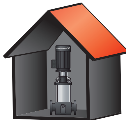
Защита от воздействия атмосферных осадков и солнечного света
