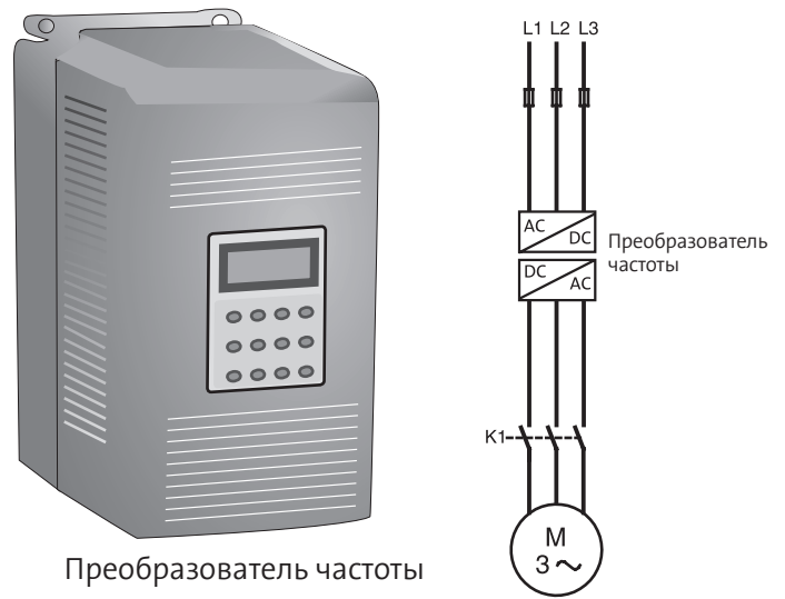
Схема электрических соединений электродвигателя, работающего с преобразователем частоты
