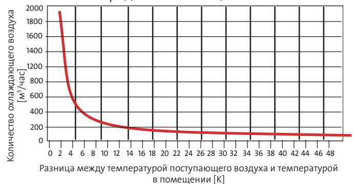
Необходимый приток воздуха для электродвигателя мощностью 4 кВт
