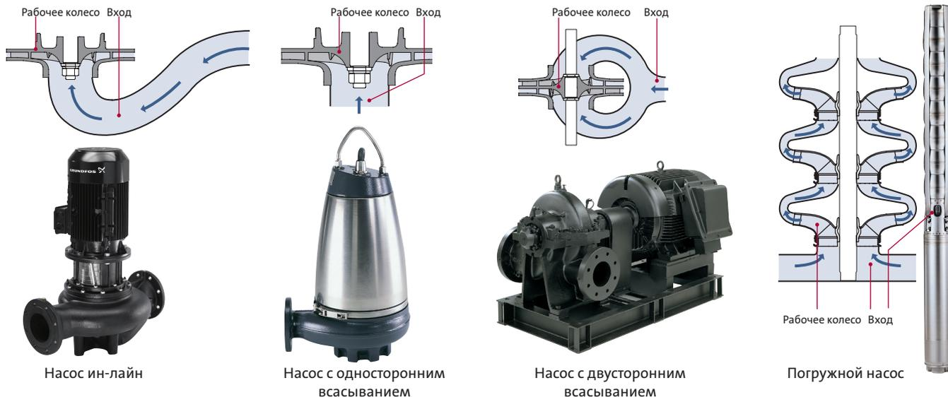
Рисунок 1.3: Вход в насосах ин-лайн, с односторонним всасыванием, двусторонним всасыванием и в погружном насосе
