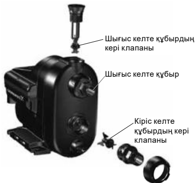
23-сур. Кіріс және шығыс келте құбырлардың кері клапандары
