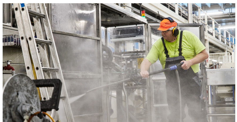
Prozesswasser wird zum Reinigen von Geräten, Böden, Oberflächen, Rohren und Becken sowie für Flaschen- und Dosenspülanlagen und weitere Bereiche innerhalb des Werks genutzt.
